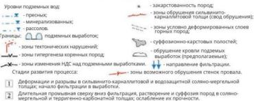
Формирование ослабленной зоны в сильвинито-карналлитовой толще с деформациями и разрушениями (свод обрушения).
